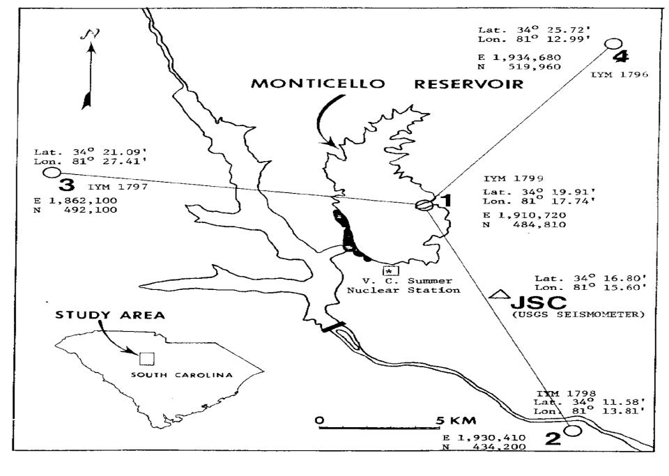
Figure 3 ORIGINAL LOCATIONS OF SCE&G 4-STATION MICROSEISMIC NETWORK
