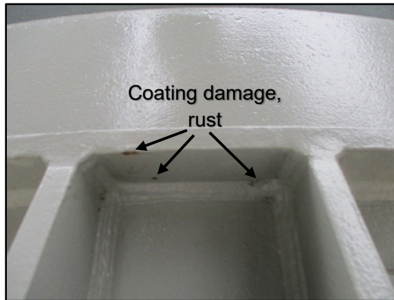
25. Anchor stud #7 area paint chip/rust
