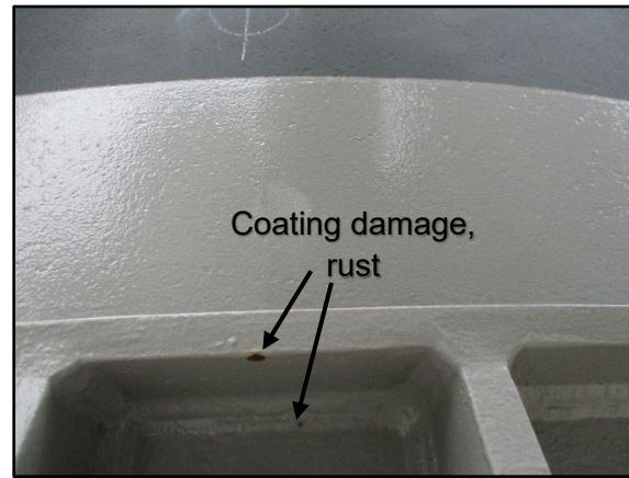
26. Anchor stud #16 area paint chip/rust
