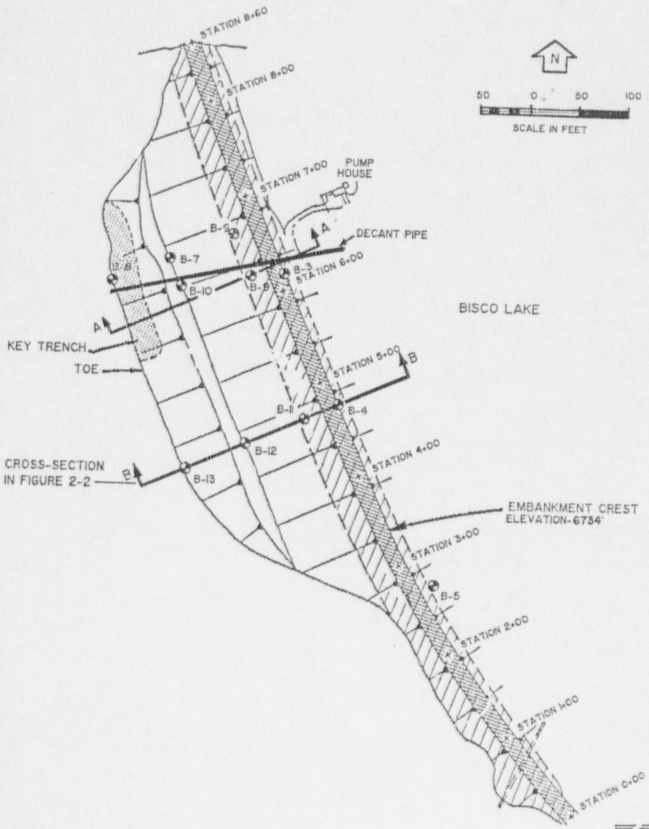
FIGURE 3-1. LOCATION OF SUBSURFACE EXPLORATION BORINGS.
