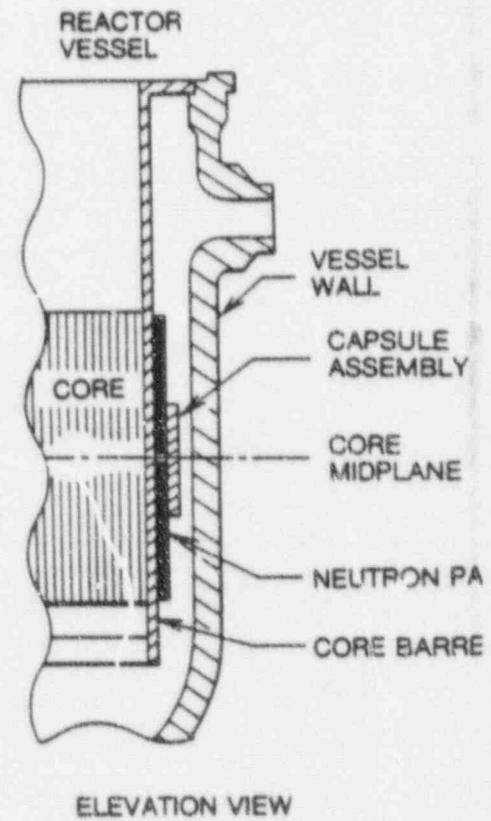
FIGURE 1-1. LOCATION OF THE IRRADIATION TEST CAPSULES IN THE CATAWBA UNIT NO. 2 REAC. VESSEL
