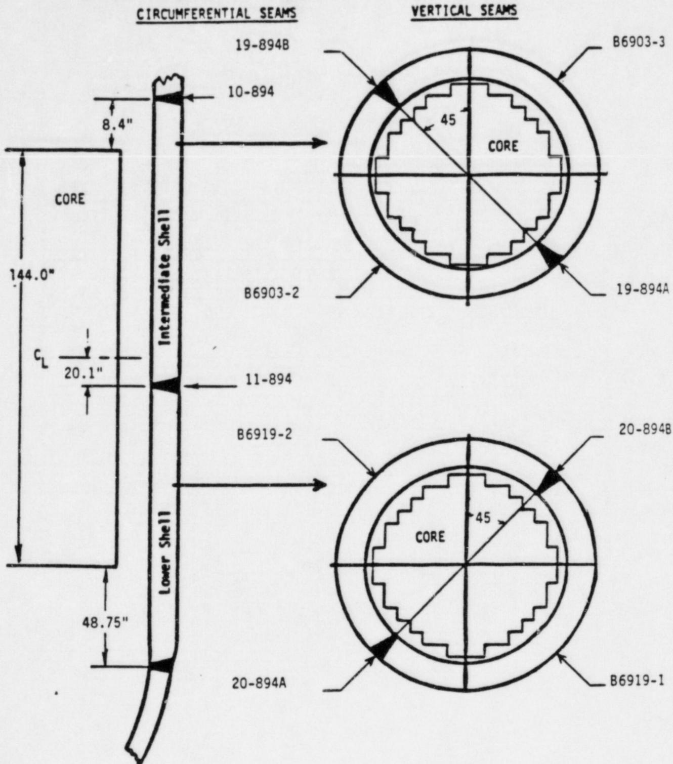
FIGURE 4 IDENTIFICATION AND LOCATION OF BELTLINE REGION MATERIAL FOR THE J.M. FARLEY UNIT 1 REACTOR VESSEL
