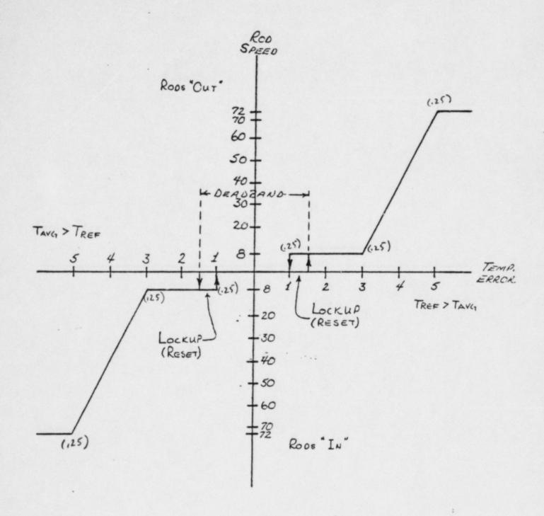
CONTROL ROD SPEED VS TEMPERATURE ERROR (AUTOMATIC ROD CONTROL)
