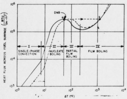
(TEMPERATURE DIFFERENCE BETWEEN FUEL ROD SURFACE AND SATURATION TEMPERATURE OF THE COOLANT)
