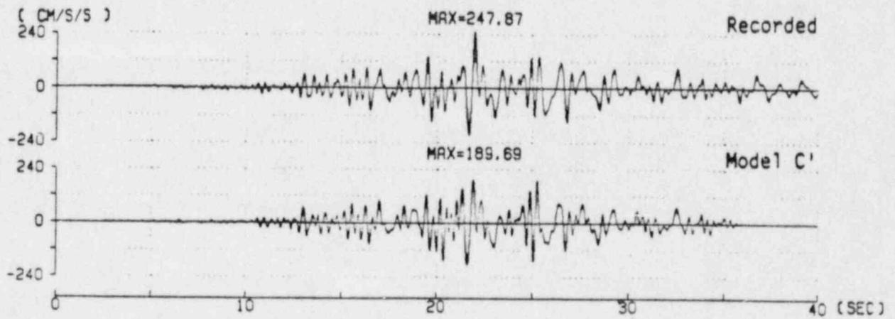
Figure 35. Acceleration Time Histories of F4US-N for Nov. 14, 1986 Earthquake
