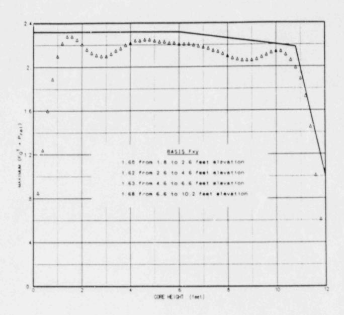
MAXIMUM (FQT . PREL) VS AXIAL CORE HEIGHT DURING NORMAL OPERATION
