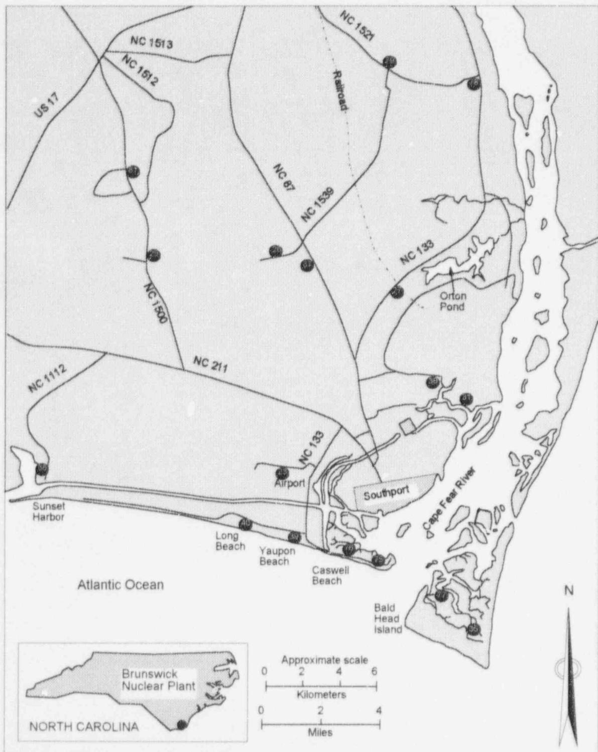
FIGURE 2-2 LOCATIONS OF RADIOPHYSICAL ENVIRONMENTAL DIRECT RADIATION MONITORS (TLD'S)
