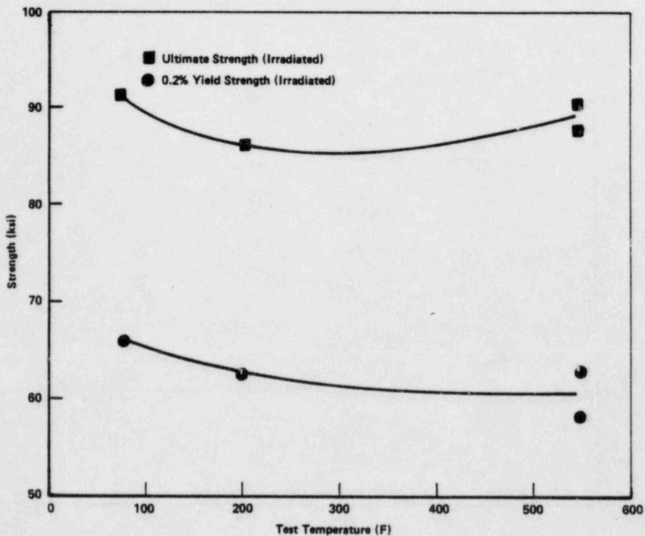
FIGURE 24. BASE METAL YIELD AND ULTIMATE TENSILE STRENGTHS VERSUS TEST TEMPERATURE FOR THE IRRADIATED TENSILE SPECIMENS FROM THE MONTICELLO 30 DEGREE SURVEILLANCE CAPSULE
