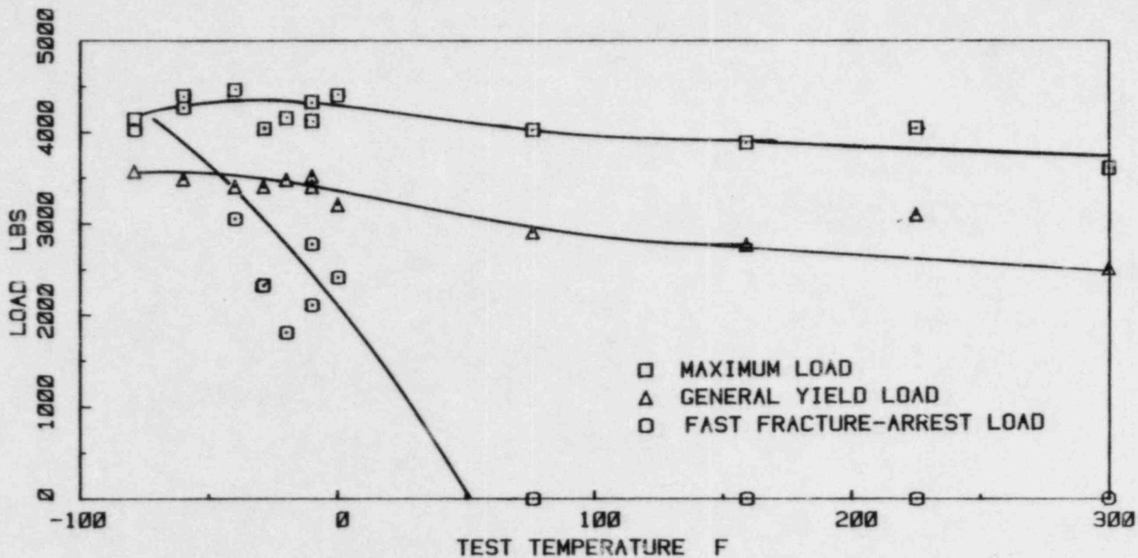
FIGURE A-10. INSTRUMENTED CHARPY LOAD VERSUS TEST TEMPERATURE FOR IRRADIATED HAZ METAL SPECIMENS FROM THE MONTICELLO 30 DEGREE SURVEILLANCE CAPSULE
