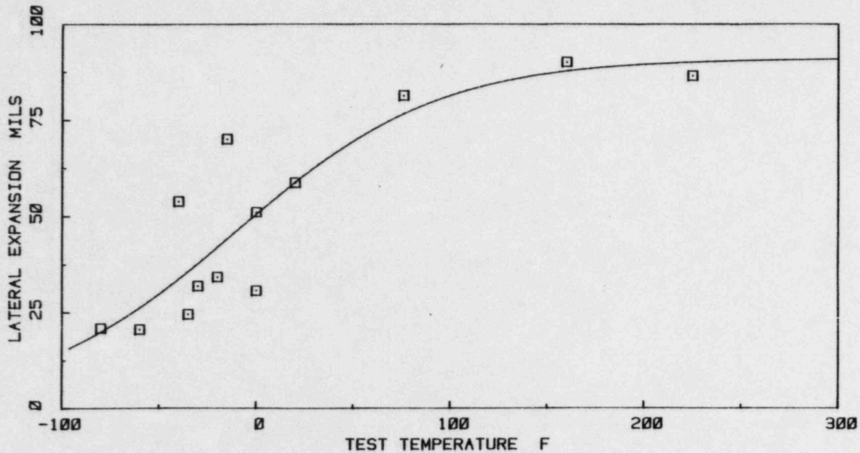
FIGURE 16. CHARPY V-NOTCH LATERAL EXPANSION VERSUS TEST TEMPERATURE FOR THE IRRADIATED WELD METAL SPECIMENS FROM THE MONTICELLO 30 DEGREE SURVEILLANCE CAPSULE
