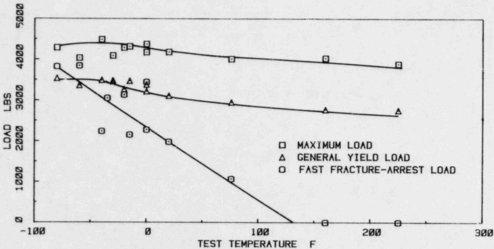
FIGURE A-9. INSTRUMENTED CHARPY LOAD VERSUS TEST TEMPERATURE FOR IRRADIATED WELD METAL SPECIMENS FROM THE MONTICELLO 30 DEGREE SURVEILLANCE CAPSULE
