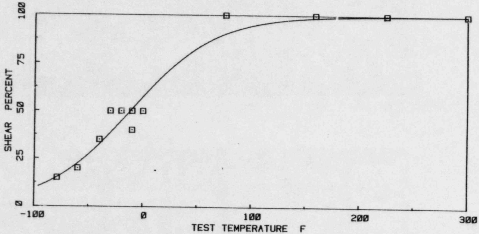
FIGURE 20. CHARPY V-NOTCH PERCENT DUCTILE SHEAR VERSUS TEST TEMPERATURE FOR THE IRRADIATED HAZ METAL SPECIMENS FROM THE MONTICELLO 30 DEGREE SURVEILLANCE CAPSULE
