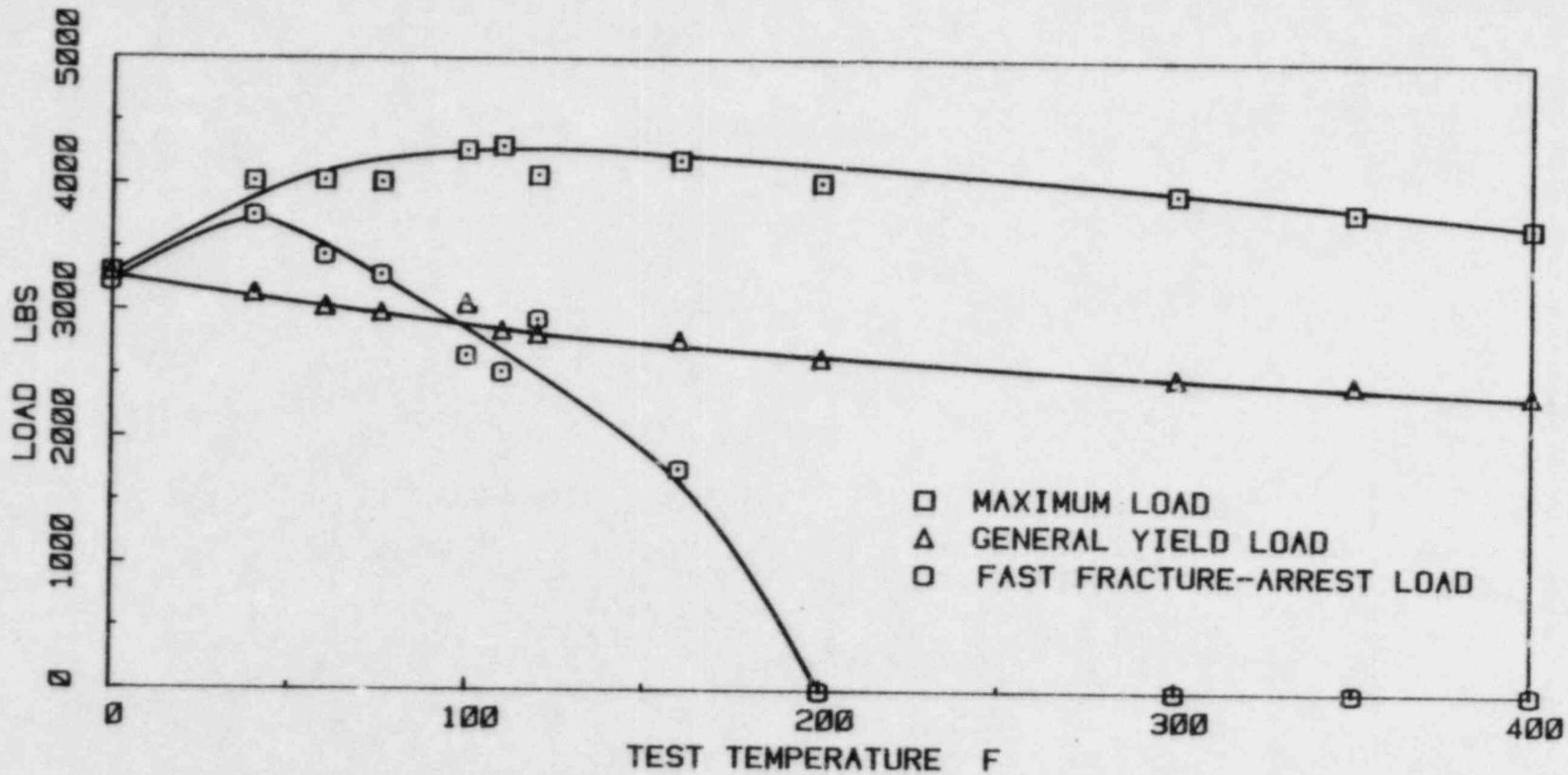
FIGURE A-8. INSTRUMENTED CHARPY LOAD VERSUS TEST TEMPERATURE FOR IRRADIATED BASE METAL SPECIMENS FROM THE MONTICELLO 30 DEGREE SURVEILLANCE CAPSULE
