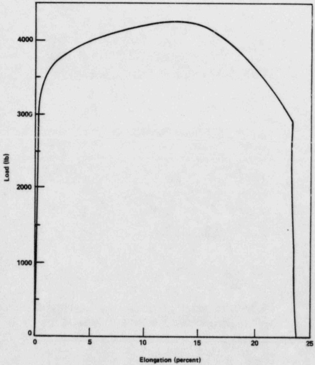
FIGURE 29. TYPICAL TENSILE LOAD-ELONGATION CURVE
