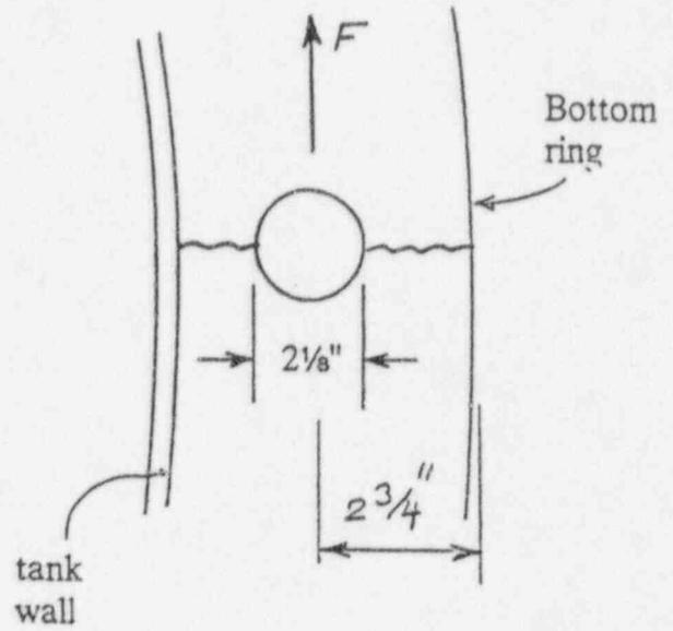
(b) Tensile Failure
