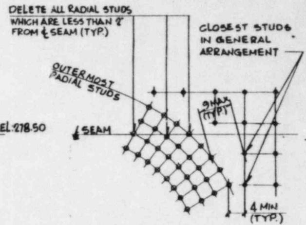
TYPICAL SPACING DETAIL AT TRANSITION BETWEEN RADIAL AND GENERAL ARRANGEMENT STUDS
