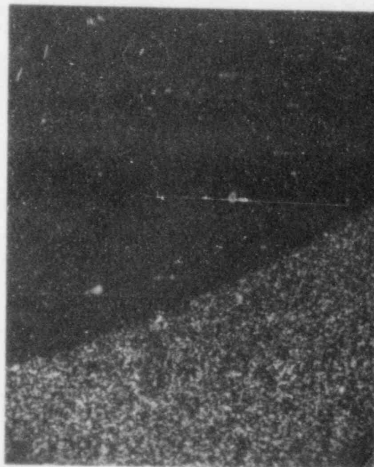
(d) Cr X-ray elemental distribution map of (a)
