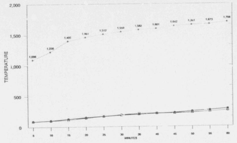
36" UPGRADED CABLE TRAY FIRE TEST THERMOCOUPLE READINGS THERMOLAG TEST 9" RULE
