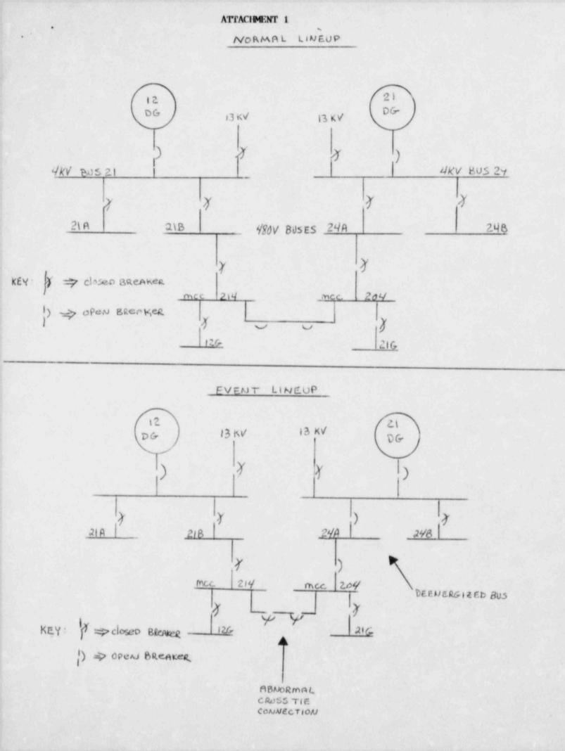
REQUIRED ELECTRICAL LINEUP DURING LOSS OF OFFSITE POWER
