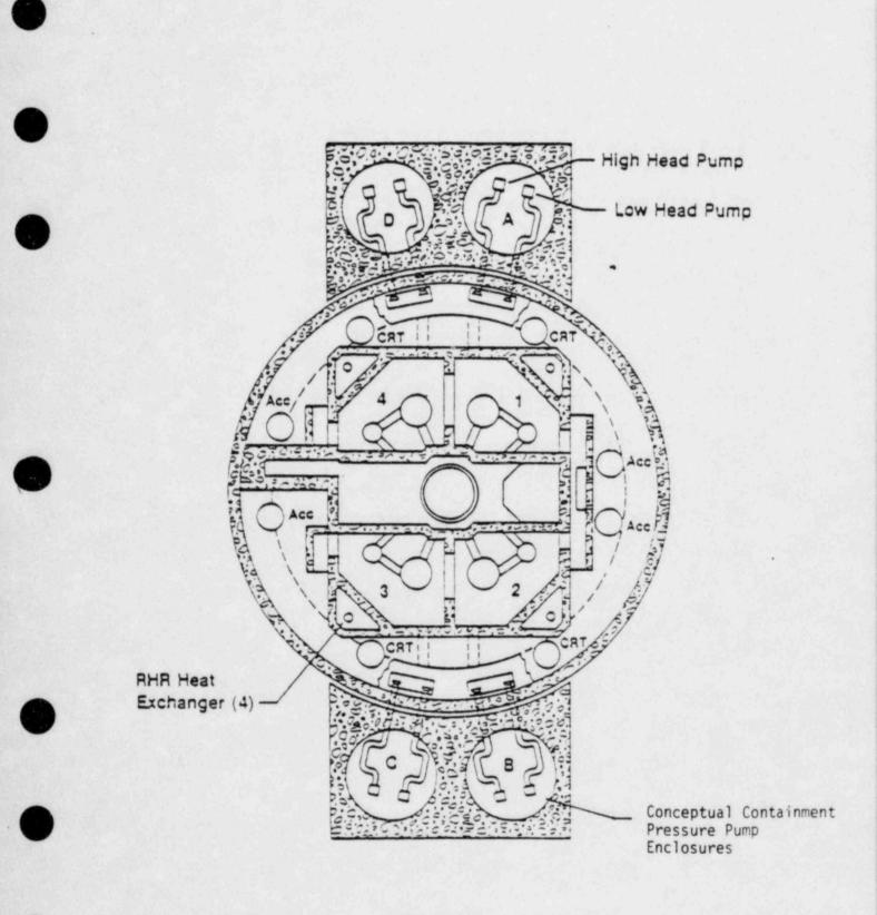
FIGURE 1.2.1-3 CONCEPTUAL CONTAINMENT PLAN
