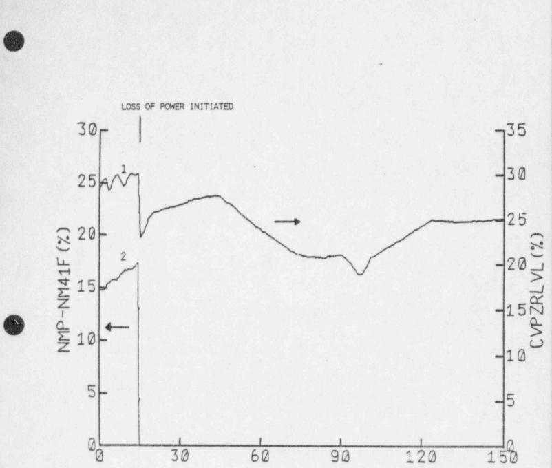
TIME (MIN) PLOT 1 - PRESSURIZER LEVEL PLOT 2 - REACTOR POWER RANGE CHANNEL 41
