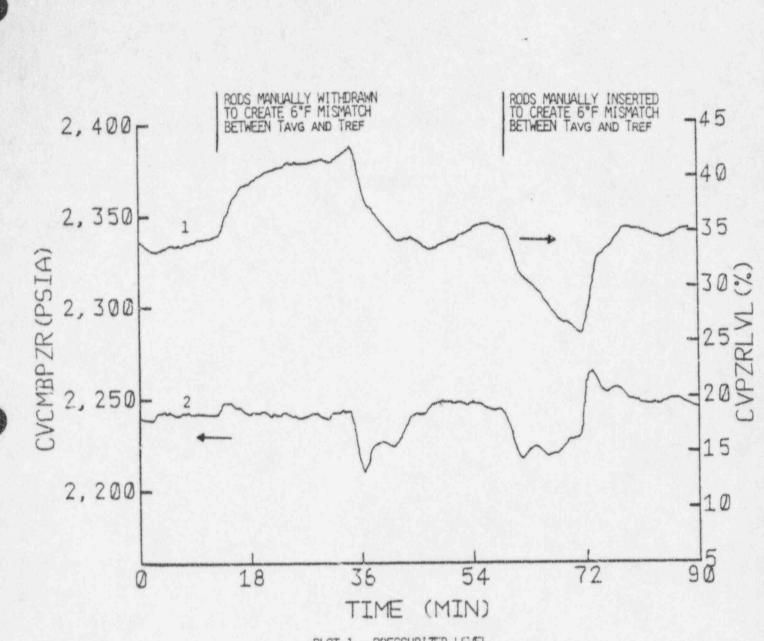
PLOT 1 - PRESSURIZER LEVEL PLOT 2 - PRESSURIZER PRESSURE
