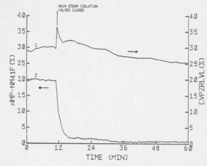
PLOT 1 - PRESSURIZER LEVEL PLOT 2 - REACTOR POWER-POWER RANGE DETECTOR CHANNEL 41
