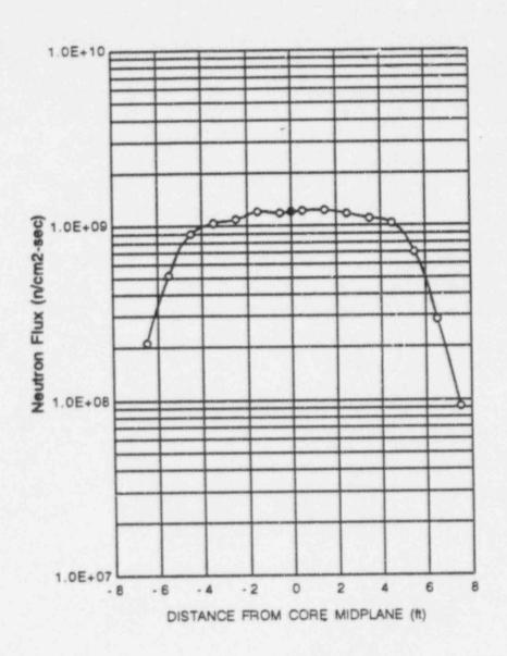
FAST NEUTRON FLUX (E > 1.0 MeV) AS A FUNCTION OF AXIAL POSITION
