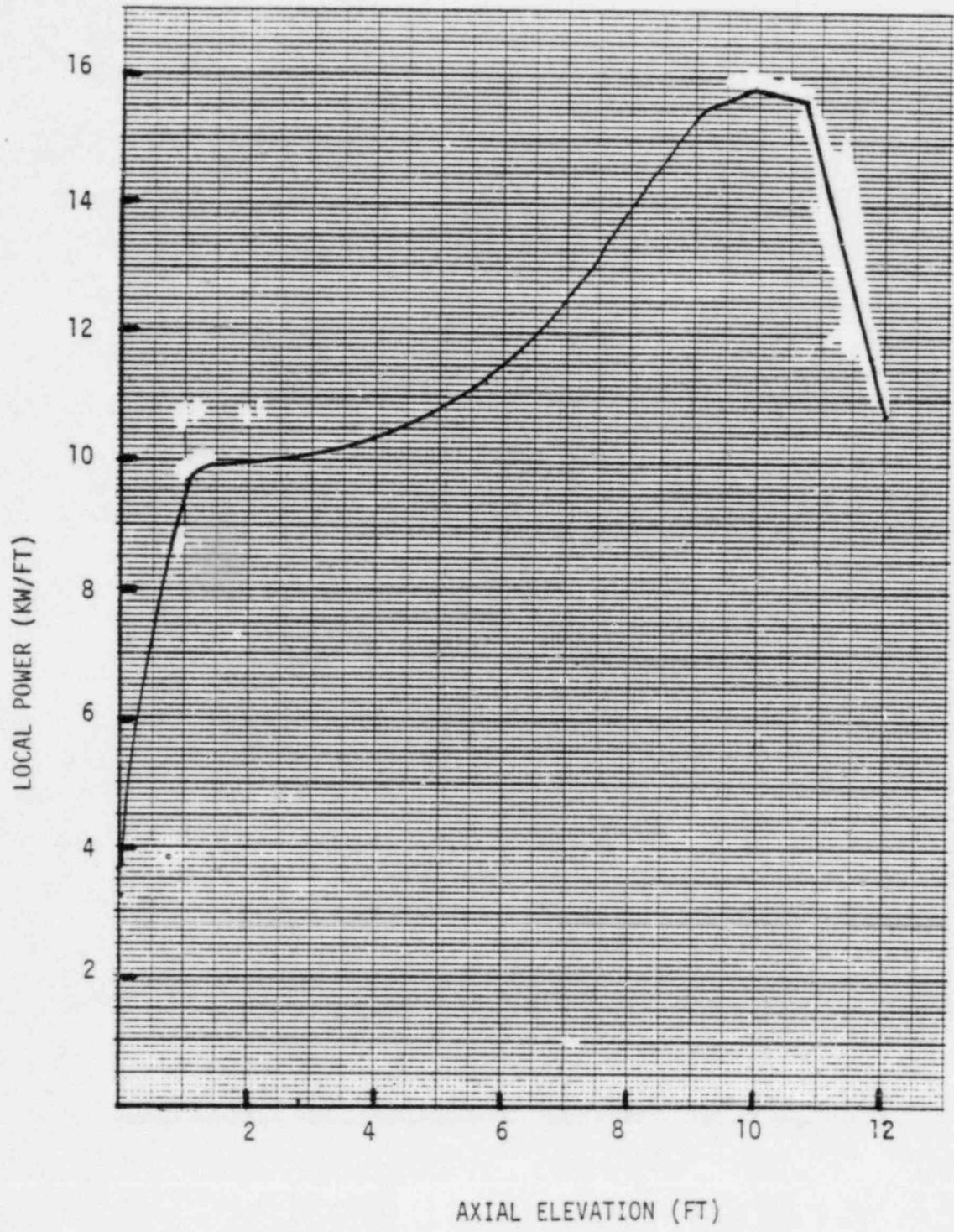
FIGURE 14.3.2-8 HOT ROD POWER DISTRIBUTION
