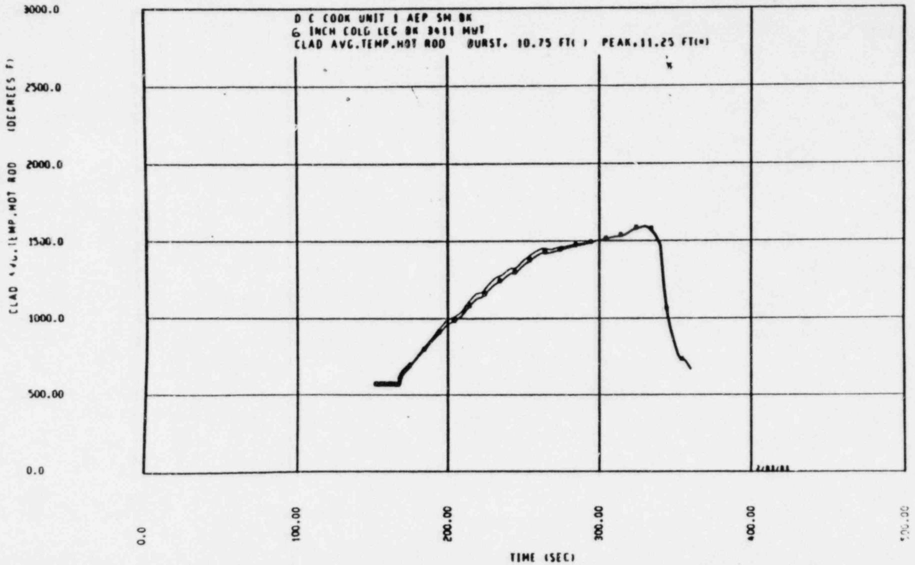
FIGURE 14.3.2-14 HOT SPOT CLAD TEMPERATURE - 6 IN. BREAK
