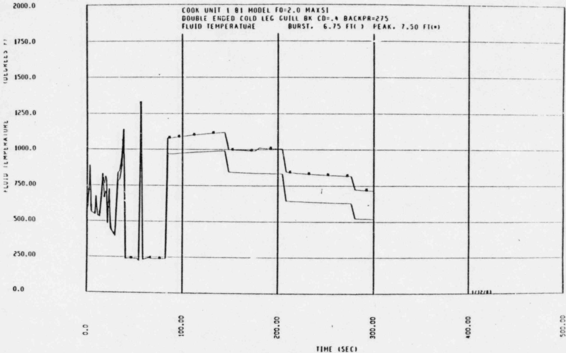
FIGURE 14.3.1-32 FLUID TEMPERATURE
