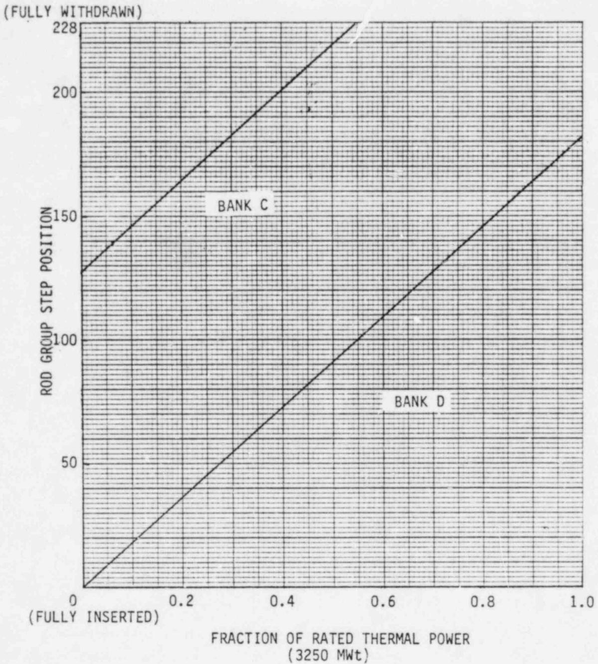
FIGURE 3.1-2 ROD GROUP INSERTION LIMITS VERSUS THERMAL POWER
