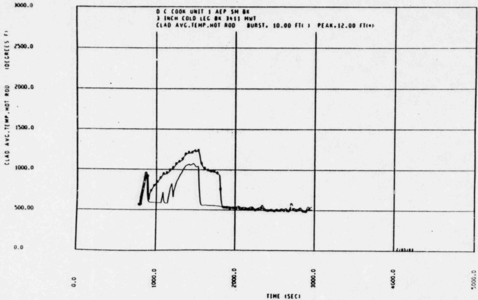
FIGURE 14.3.2-13 HOT SPOT CLAD TEMPERATURE - 3 IN. BREAK
