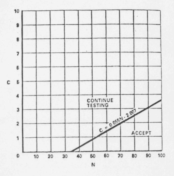
FIGURE 4.7-1 SAMPLE PLAN 2) FOR SNUBBER FUNCTIONAL TEST
