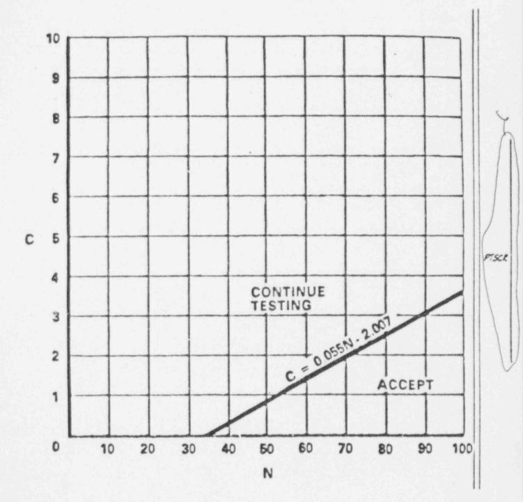
FIGURE 4.7-1 SAMPLE PLAN 2) FOR SNUBBER FUNCTIONAL TEST
