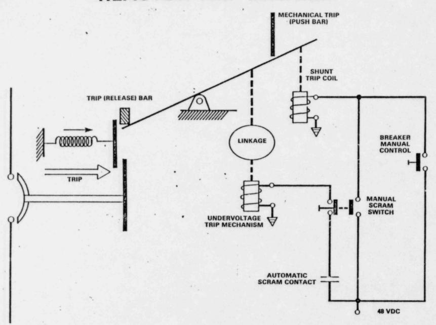
UNDERVOLTAGE TRIP MECHANISM
