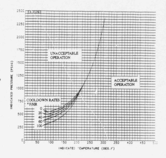
SALEM UNIT 2 REACTOR COOLANT SYSTEM COOLDOWN LIMITATIONS APPLICABLE FOR THE FIRST 15 EFPY WITH MAXIMUM COOLDOWN RATE OF 100 F/HR. CURVE CONTAINS NO MARGIN FOR INSTRUMENT ERRORS.
