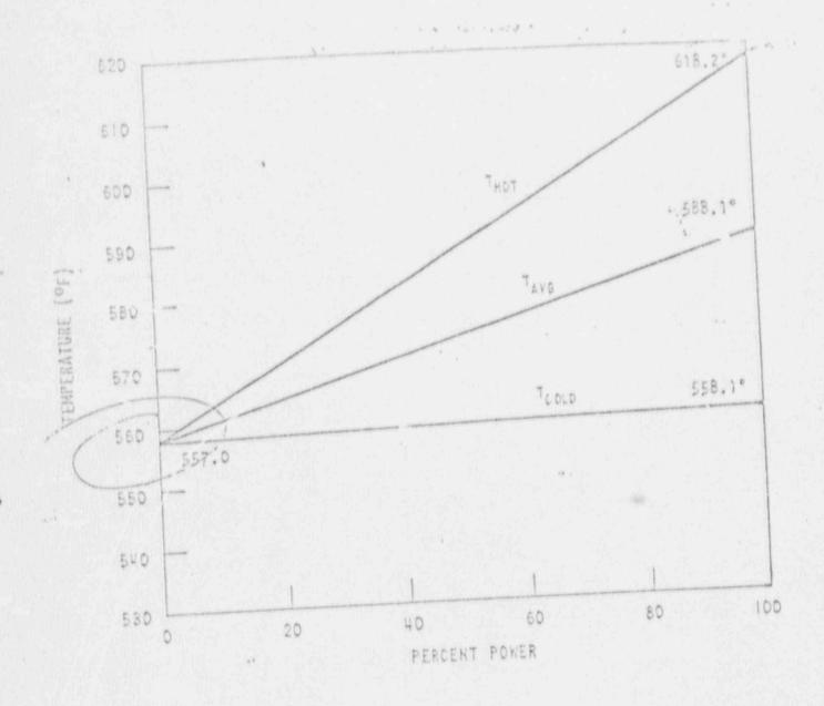
RELATIONSHIP BETWEEN REACTOR COOLANT SYSTEM TEMPERATURE AND POWER
