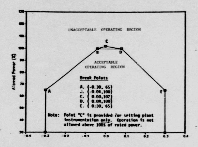
FIGURE 2.5-1 AXIAL SHAPE INDEX VS. PERCENT OF ALLOWABLE POWER LEVEL
