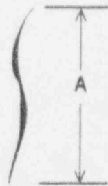
Case A: Axial Crack
