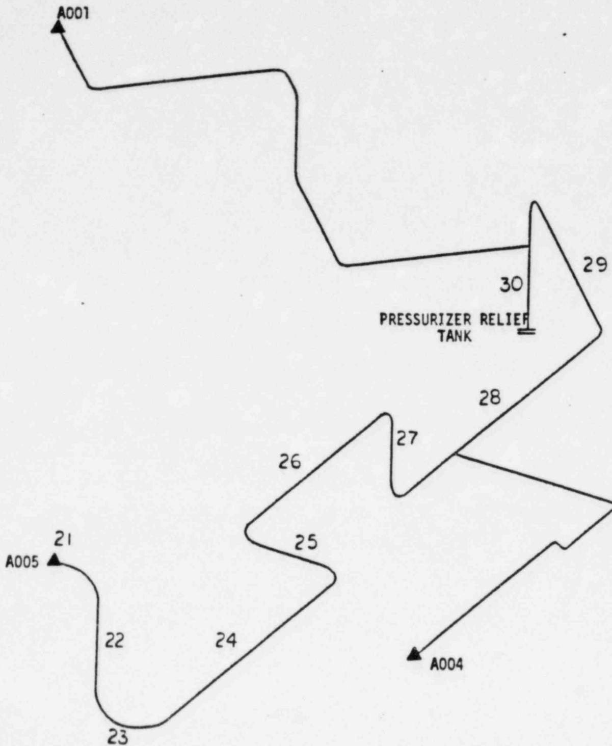
FIGURE 4-2B: RELIEF LINE HYDRAULIC MODEL
