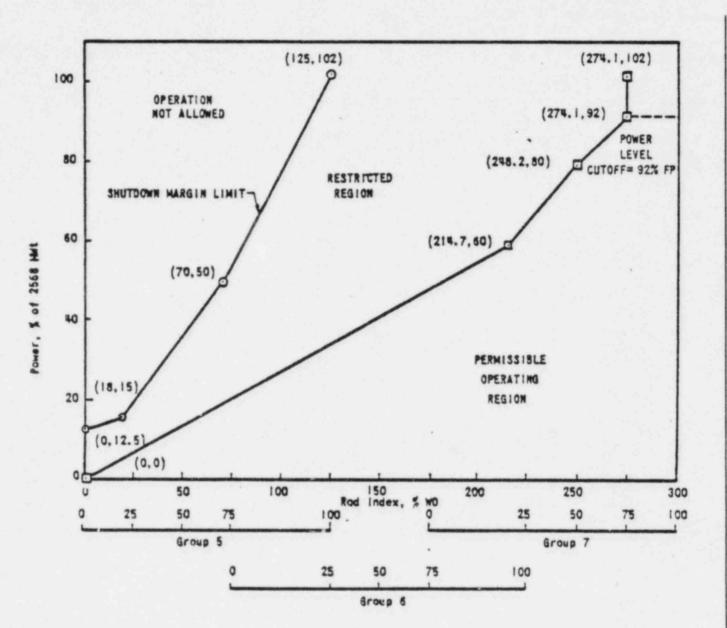
ROD POSITION LIMITS FOR FOUR PUMP OPERATION FROM 0 TO 100 ± 10 EFPD UNIT 1
