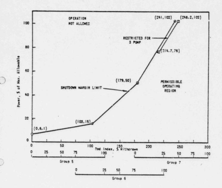
ROD POSITION LIMITS FOR TWO AND THREE PUMP OPERATION AFTER 100 ± 10 EFPD UNIT 1
