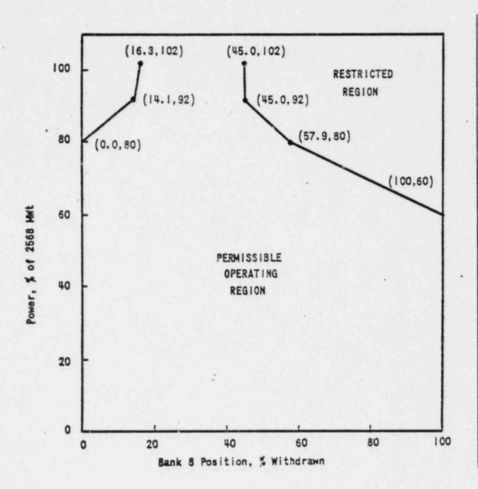
APSR POSITION LIMITS FOR OPERATION FROM 0 to 100 ± 10 EFPD UNIT 1
