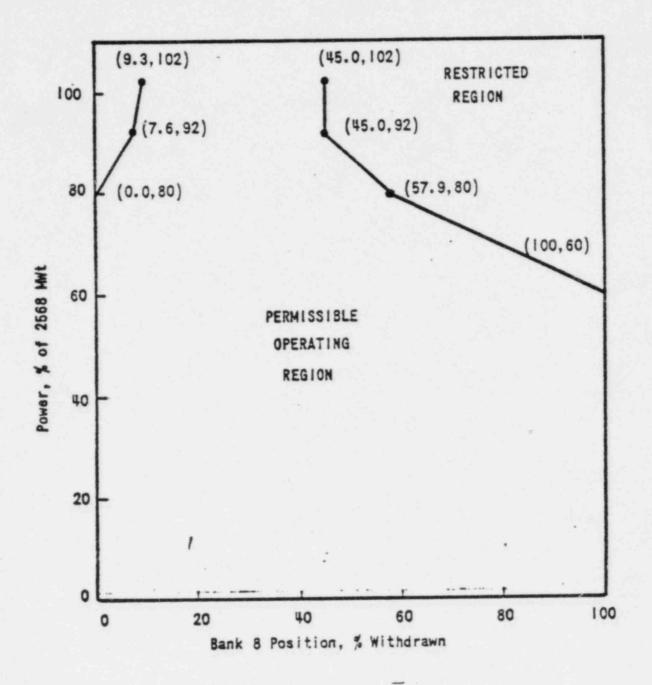
APSR POSITION LIMITS FOR OPERATION AFTER 100 + 10 EFPD Unit 1
