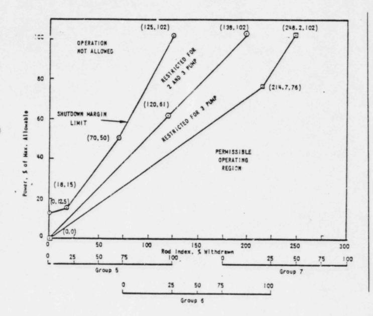
ROD POSITION LIMITS FOR TWO AND THREE PUMP OPERATION FROM 0 TO 100 + 10 EFPD UNIT 1
