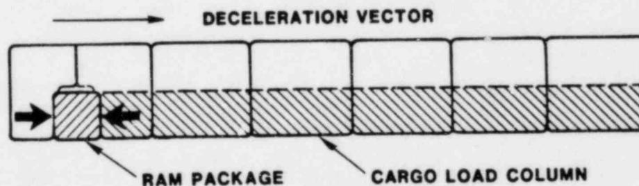
Figure 1. Longitudinal Crush Scenario
