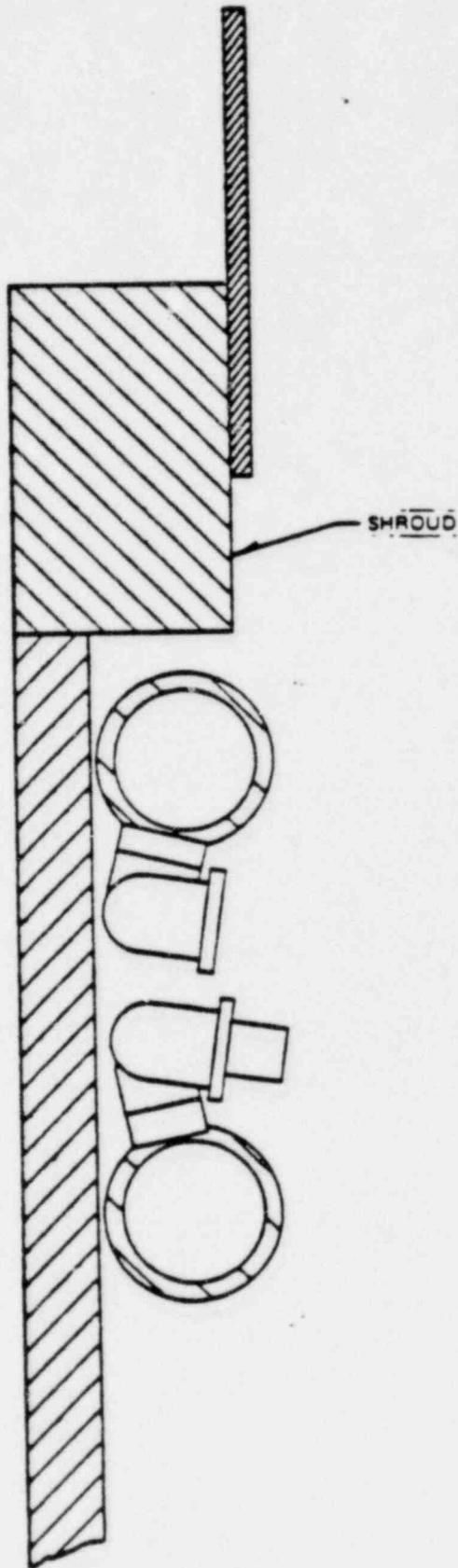
Figure 2-4. Sparger Nozzles
