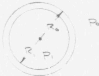
NOTE THAT FOR THE TUBE THE PRESSURE FORCE ACTS ON THE U-BEND END OF THE TUBE. THE AXIAL FORCE BALANCE GIVES,
