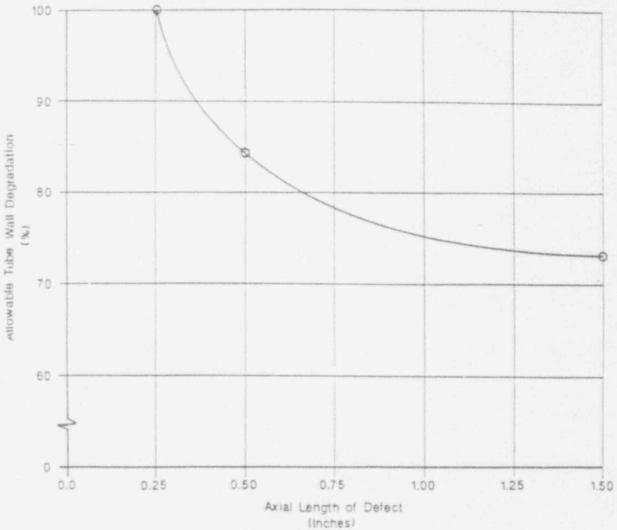
ALLOWABLE TUBE WALL DEGRADATION
