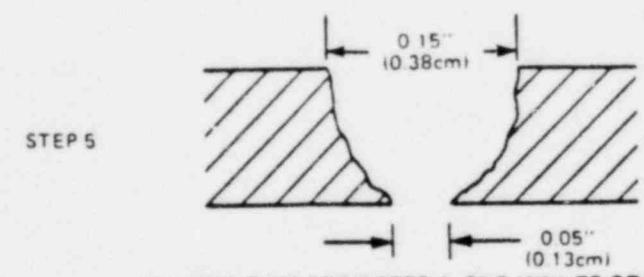
RAPID EROSION AT INNER WALL
