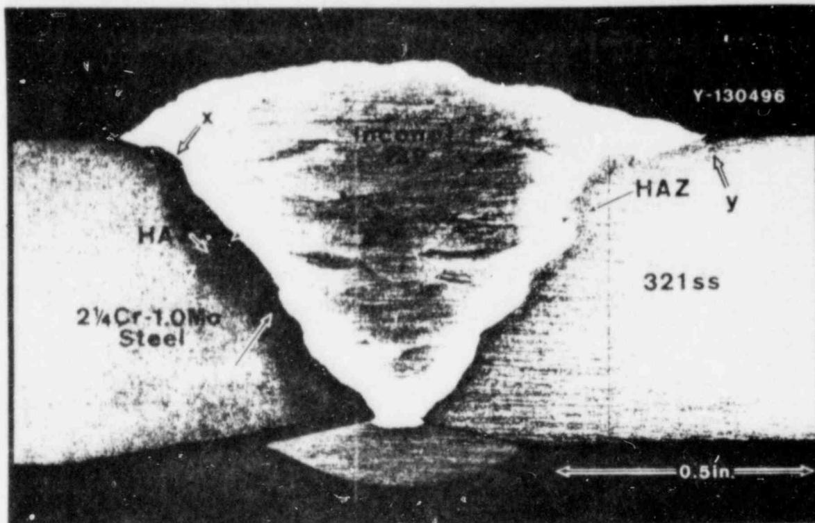
LONGITUDINAL CROSS SECTION OF TRANSITION JOINT
