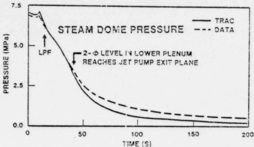
FIG. 9 COMPARISON OF SYSTEM PRESSURE
