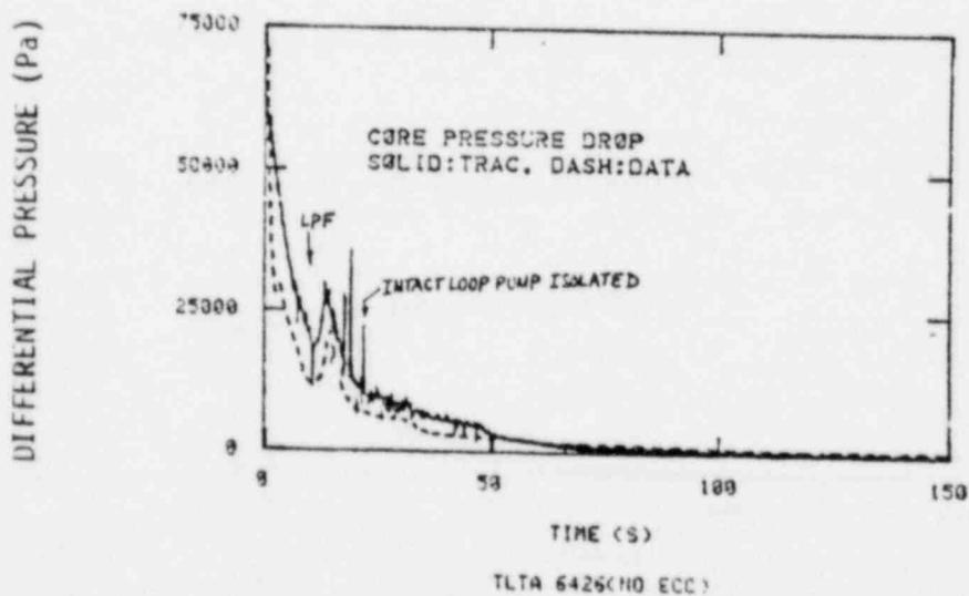
FIG. 7 COMPARISON OF BUNDLE PRESSURE DROP
