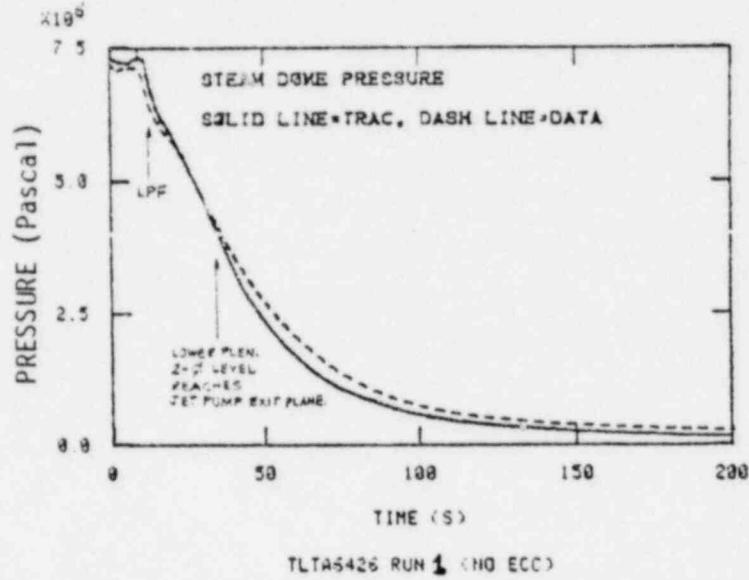
FIG. 1 COMPARISON OF SYSTEM PRESSURE
