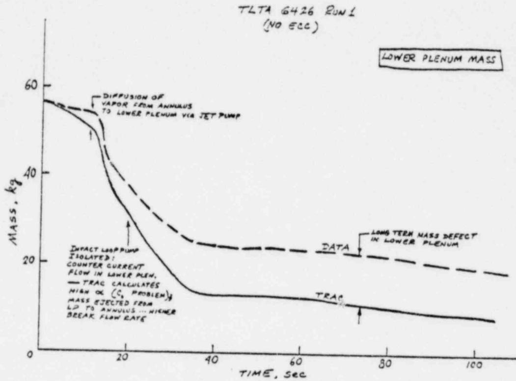
FIG. 6 COMPARISON OF LOWER PLENUM MASS
