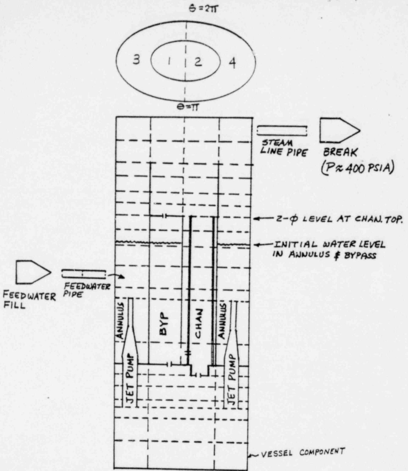
FIG.4 TRAC/TLTA NODALIZATION FOR 6441 Run 6-1
