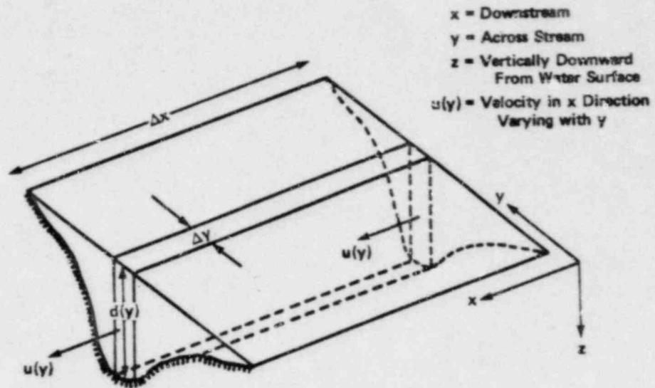
FIGURE 1. MODEL OF AN INFINITESIMAL STREAM TUBE IN A NATURAL STREAM
