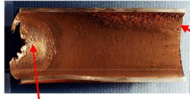
HRSG tube failure (EPRI, 2005)
