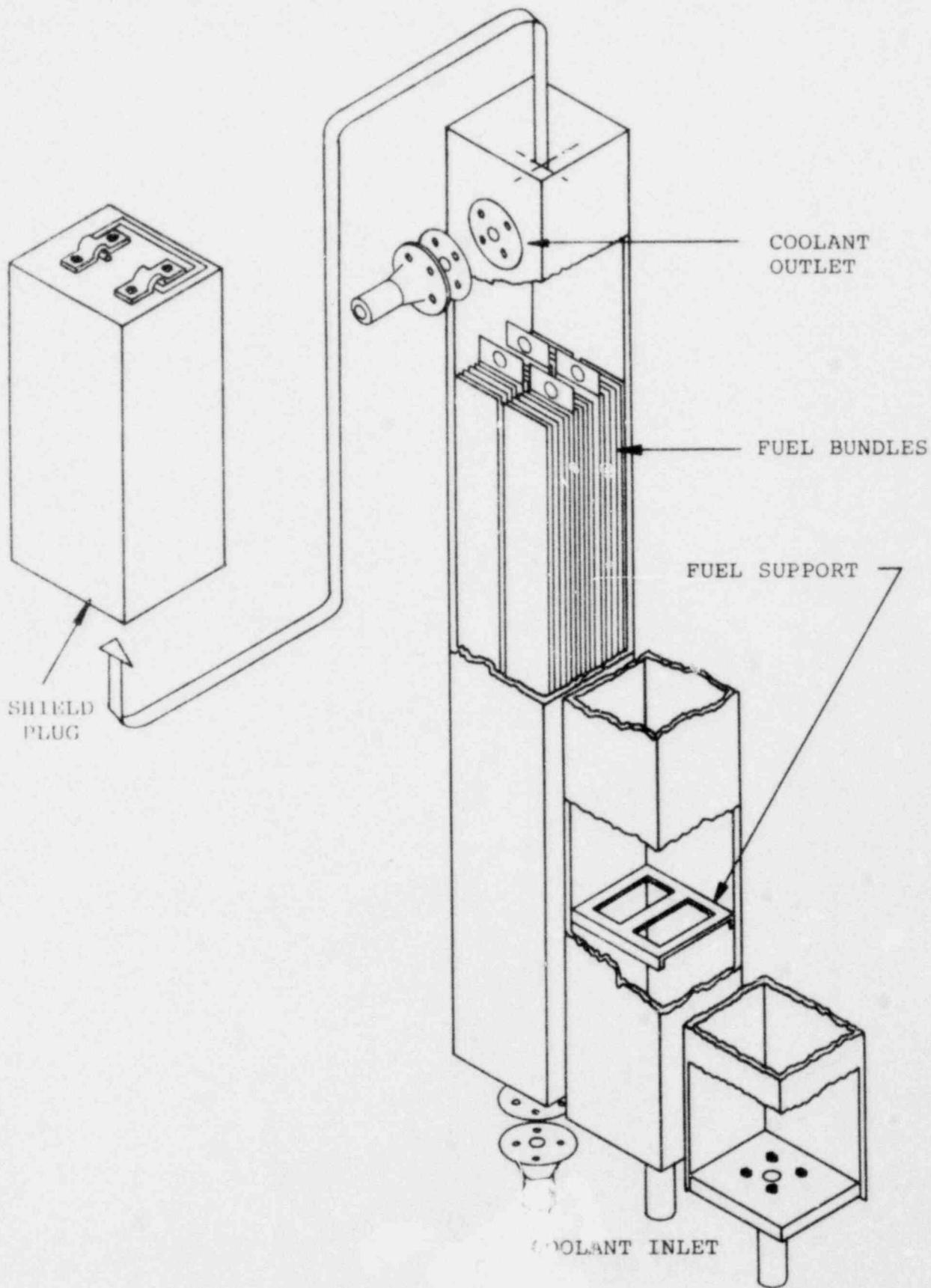
Figure 4-9. ISOMETRIC OF UFTR FUEL BOXES.
