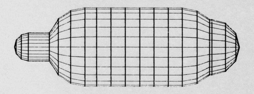
FINITE ELEMENT MODEL OF VESSEL
