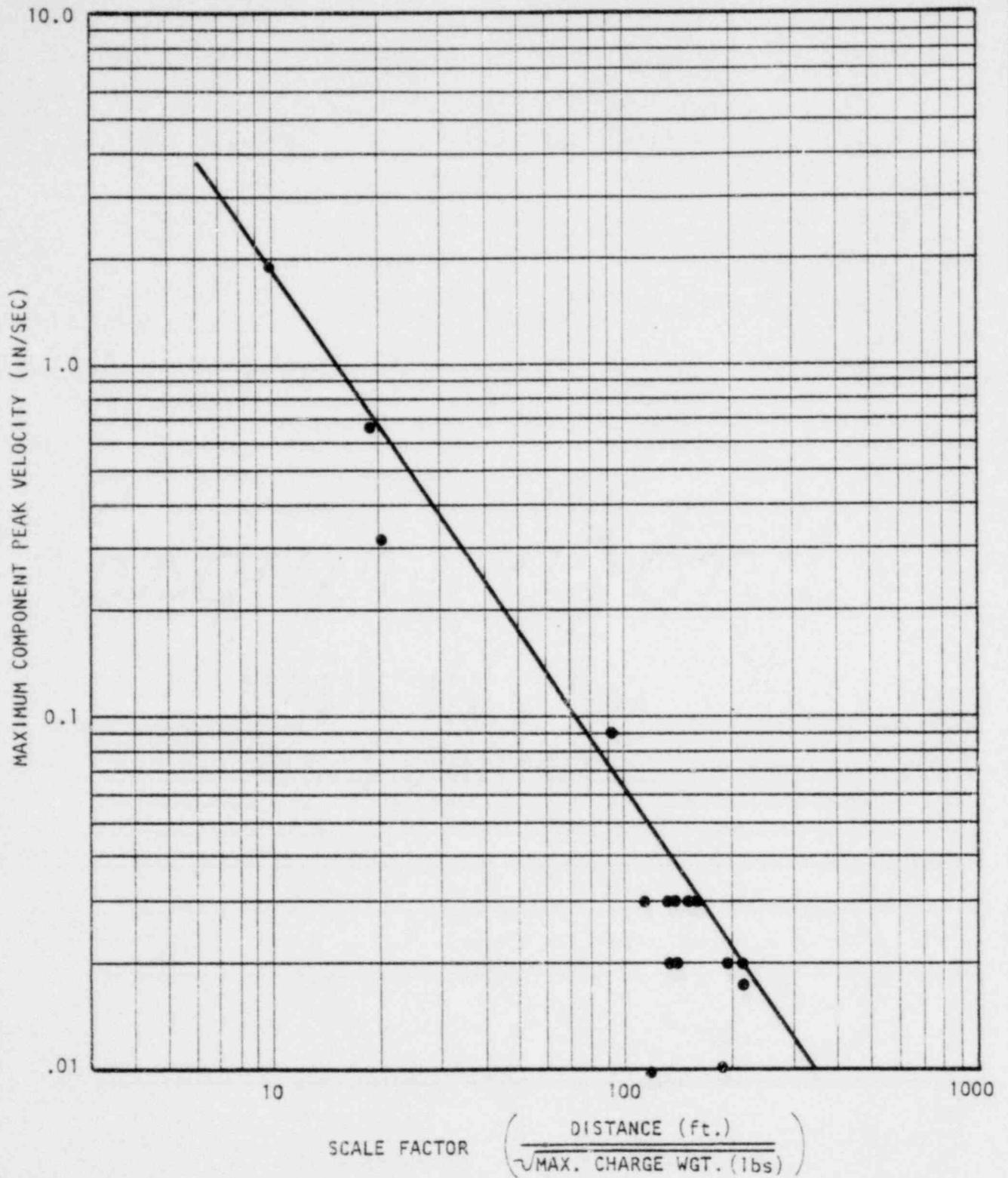
SITE SPECIFIC ATTENUATION OF PEAK COMPONENT PARTICLE VELOCITY FROM QUARRY BLASTING NEAR LIMERICK STATION
