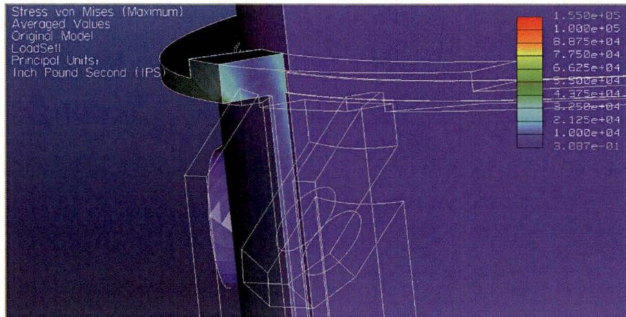
Figure A2.10.2-6: Stress Distribution in the Tie-Down Band
