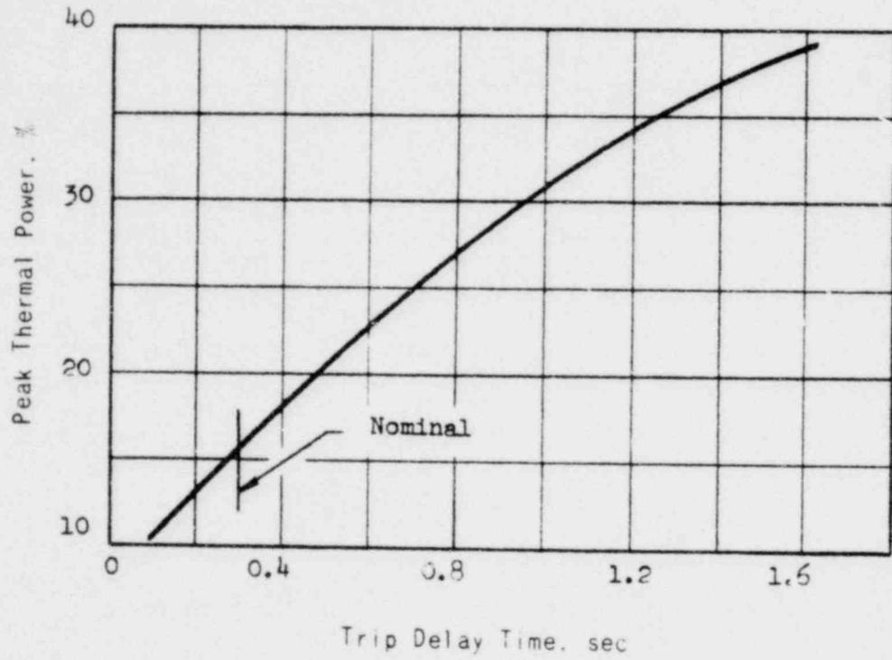
PEAK THERMAL POWER VERSUS TRIP DELAY TIME
