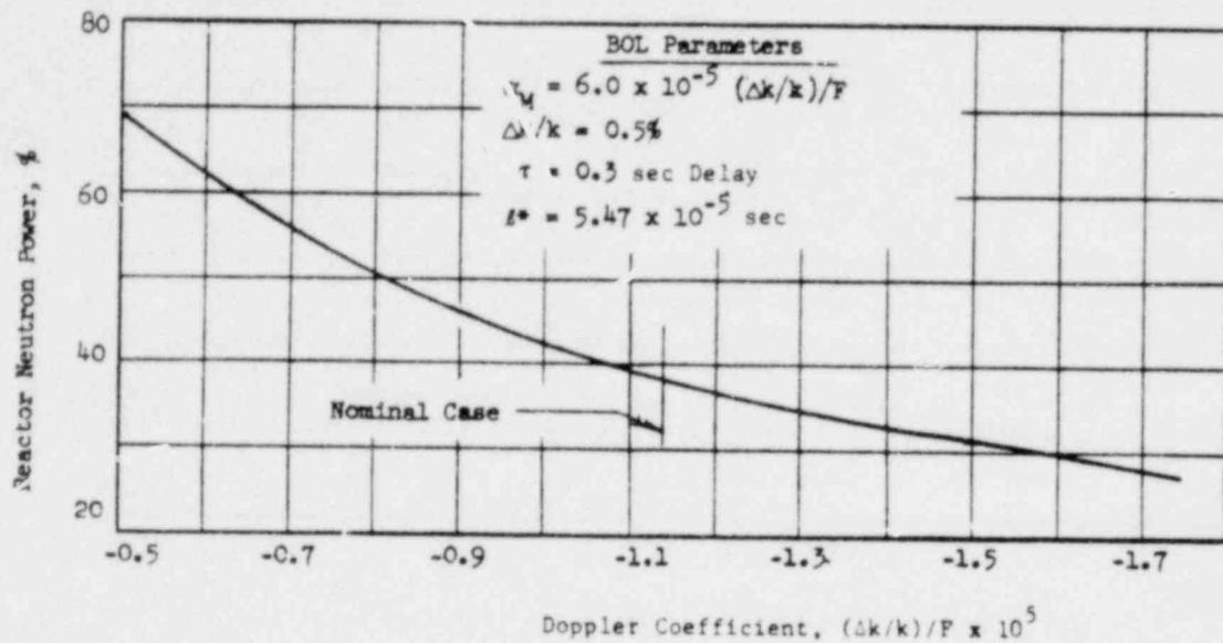
THE EFFECT ON REACTOR NEUTRON POWER OF
