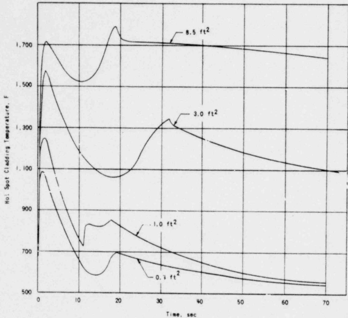
HOT SPOT CLADDING TEMPERATURE VERSUS TIME FOR SPECTRUM OF COLD LEG RUPTURES
