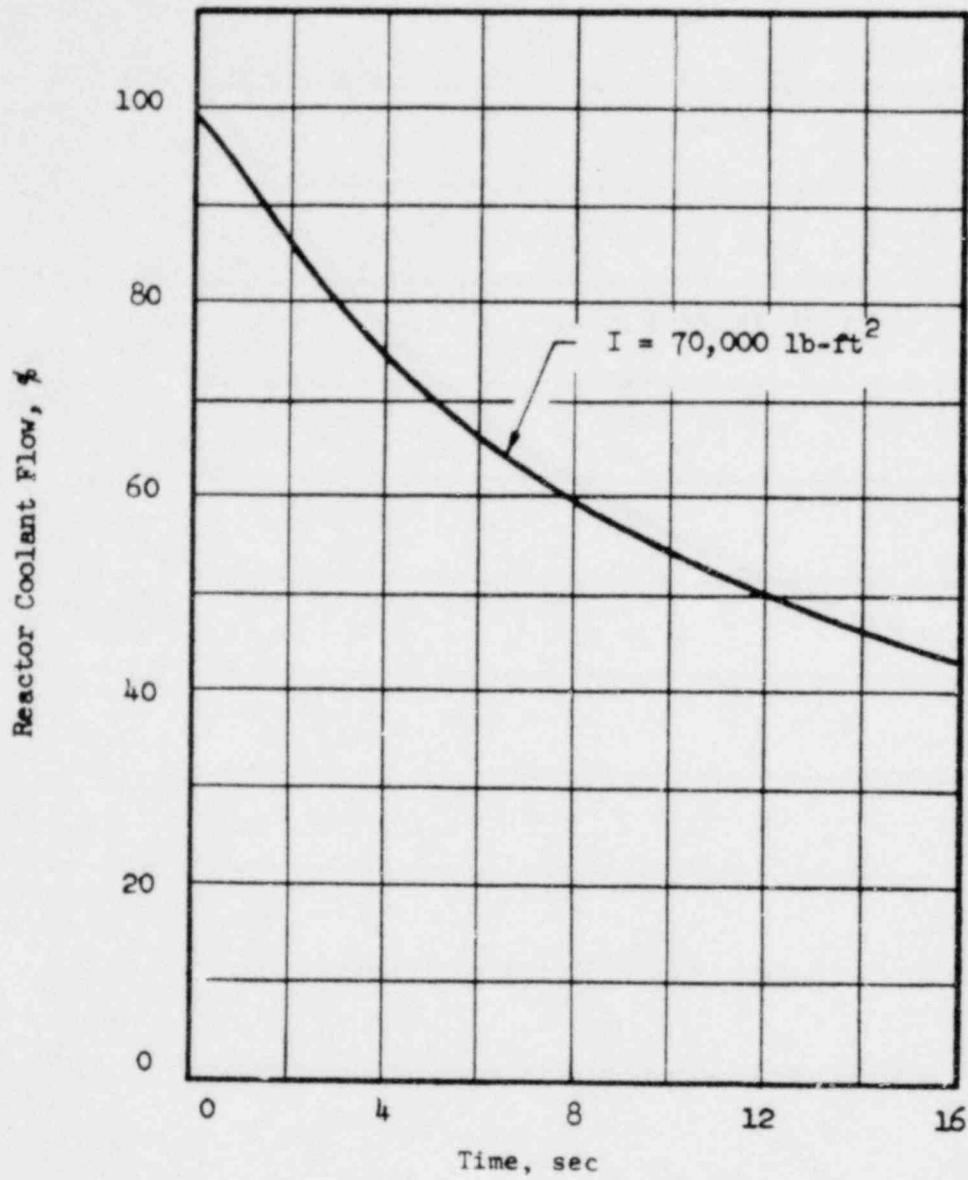
PERCENT REACTOR COOLANT FLOW AS A FUNCTION OF TIME AFTER LOSS OF PUMP POWER
