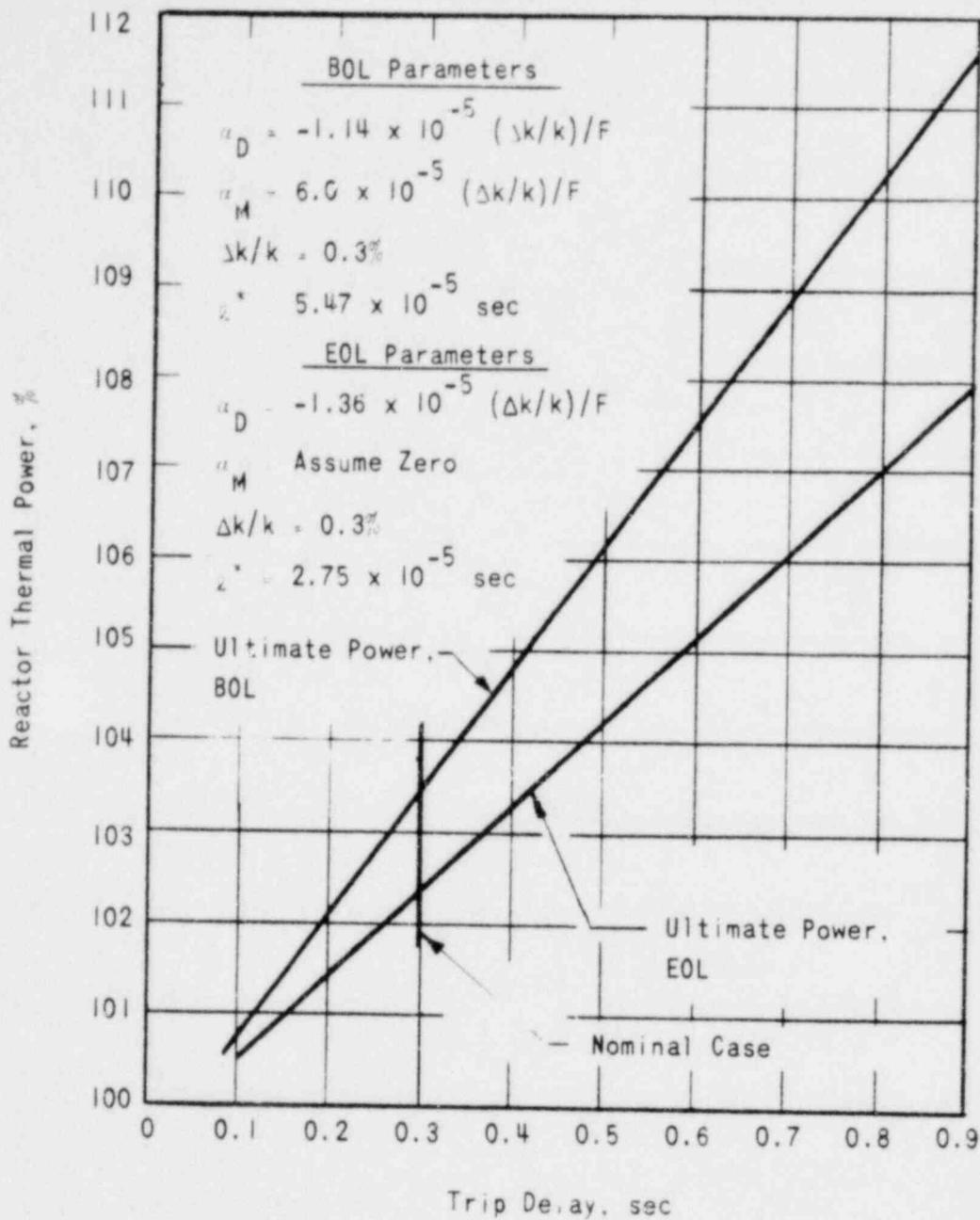
REACTOR THERMAL POWER VERSUS TRIP
