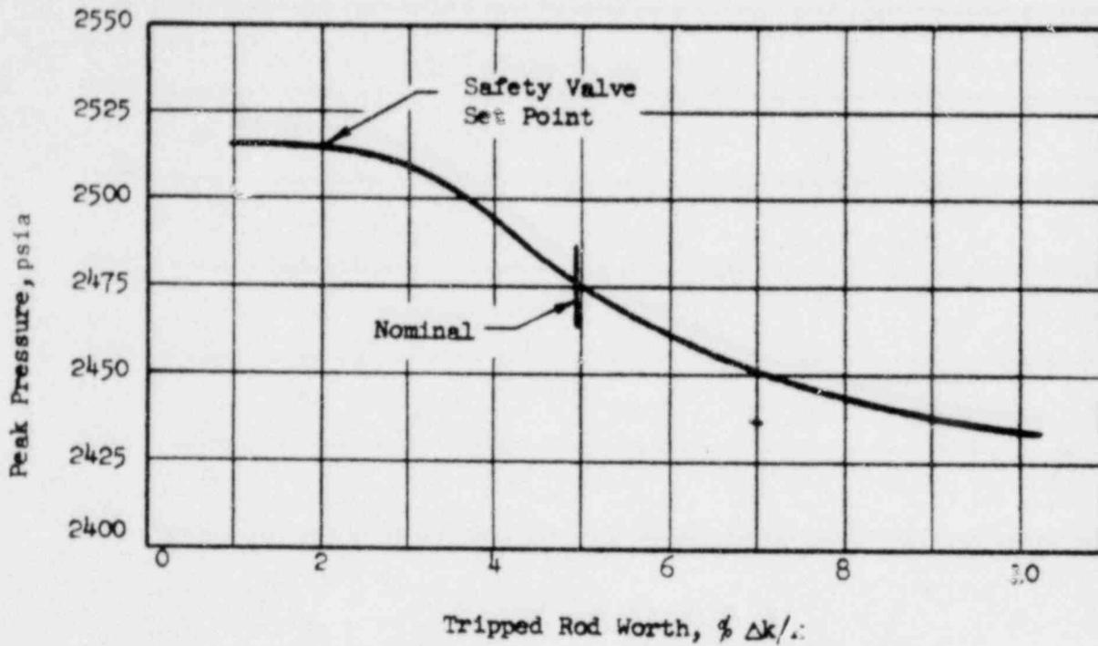
PEAK PRESSURE VERSUS TRIPPED ROD WORTH FOR
