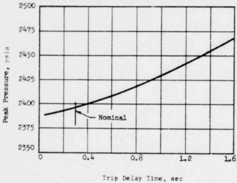
PEAK PRESSURE VERSUS TRIP DELAY TIME FOR A ROD WITHDRAWAL ACCIDENT FROM RATED POWER USING A 1.2%  $\Delta K/K$  ROD GROUP; HIGH PRESSURE REACTOR TRIP IS ACTUATED
