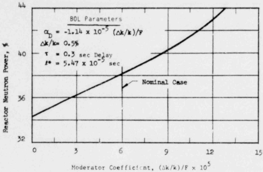
THE EFFECT ON REACTOR NEUTRON POWER OF
