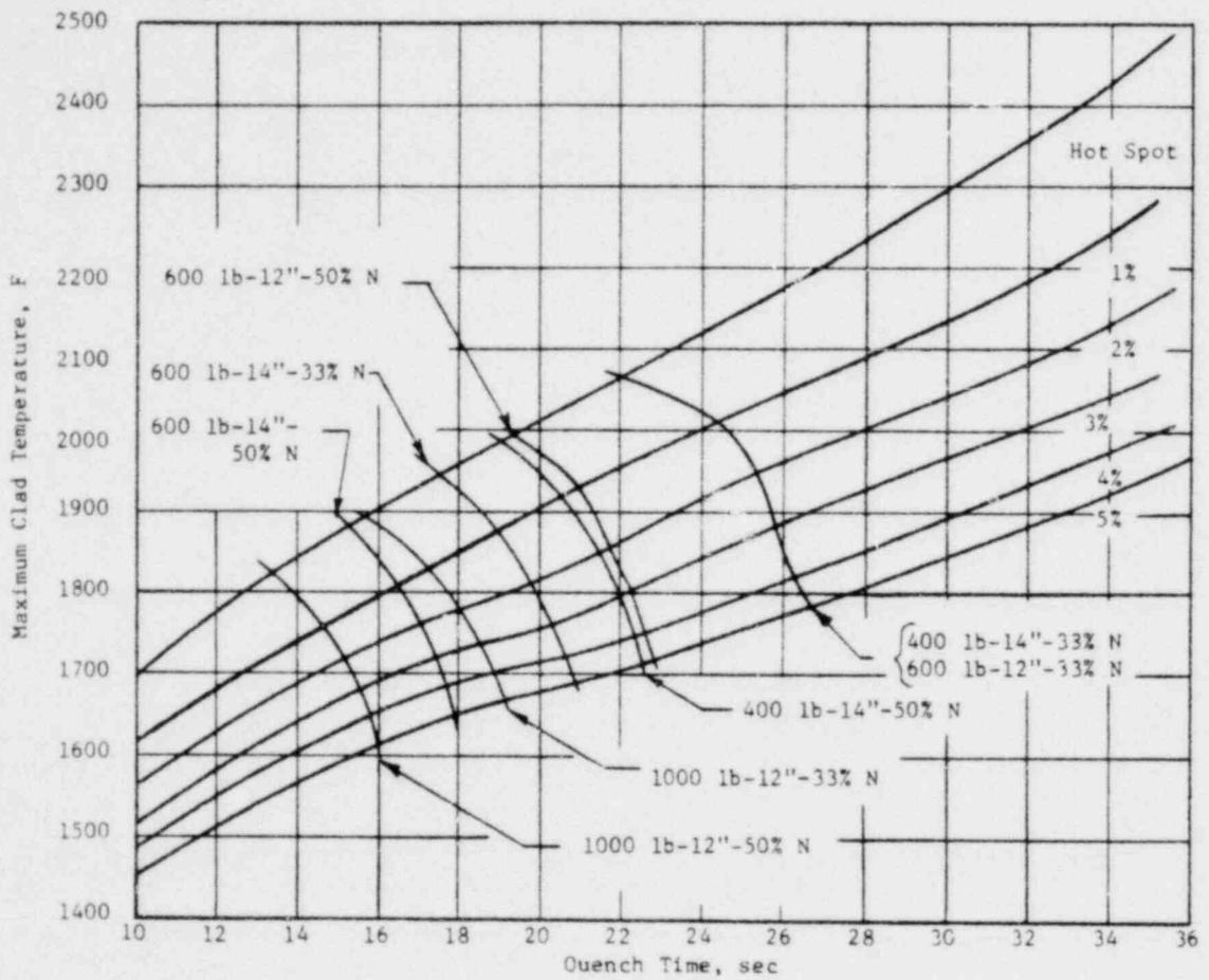
CORE FLOODING TANK ANALYSIS; MAXIMUM CLAD TEMPERATURE VERSUS TIME TO QUENCH FOR A 36 IN. ID, DOUBLE-ENDED PIPE RUPTURE
