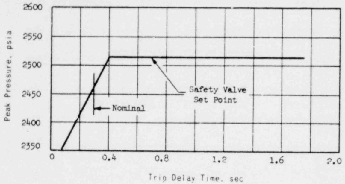
PEAK PRESSURE VERSUS TRIP DELAY TIME FOR A
