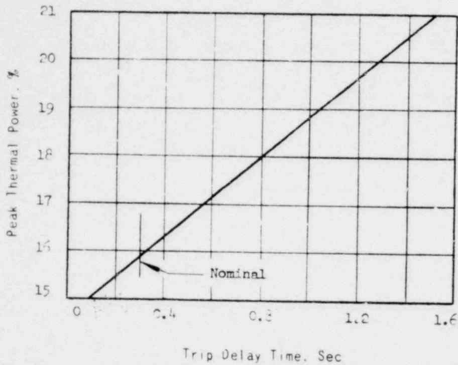
PEAK THERMAL POWER VERSUS TRIP DELAY TIME
