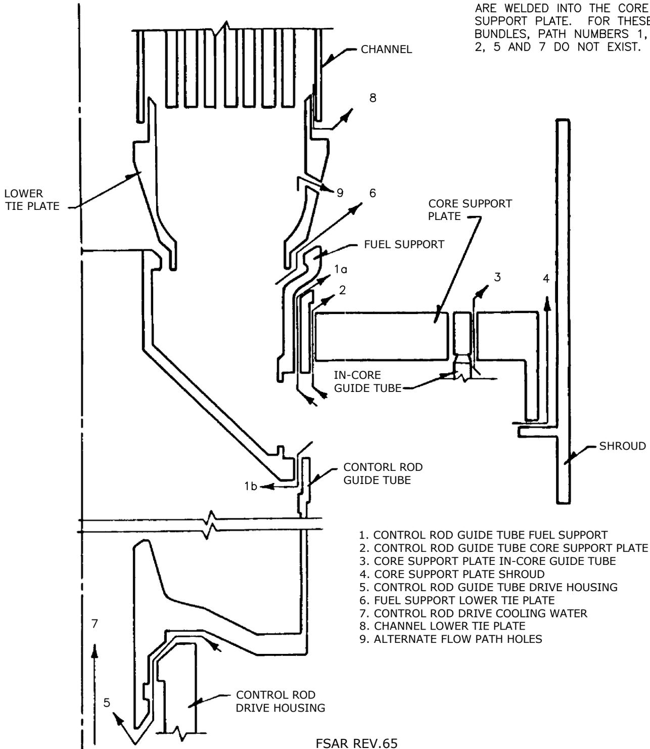
1. CONTROL ROD GUIDE TUBE FUEL SUPPORT
