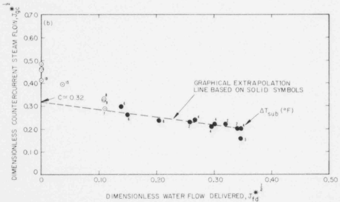
Figure 8. ILLUSTRATION OF THE DIFFICULTY OF DATA EXTRAPOLATION TO COMPLETE BYPASS
