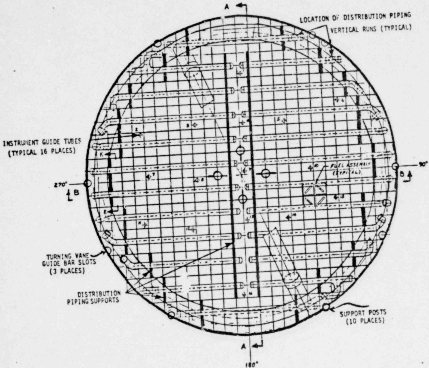
FIGURE 4 PLAN VIEW OF THE DISTRIBUTION PIPES RELATIVE TO THE TURNING VANE GRID.
