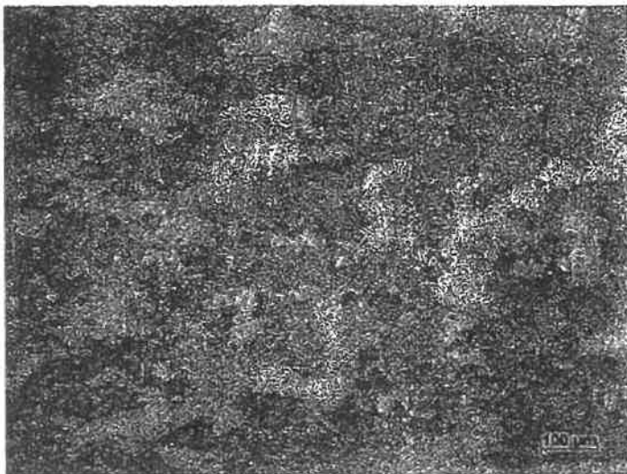
< ThO 2 Particle size, Dispersion > Metallurgical microscope 【ThO 2 粒径・分散】 金属顕微鏡 : 1,000倍
