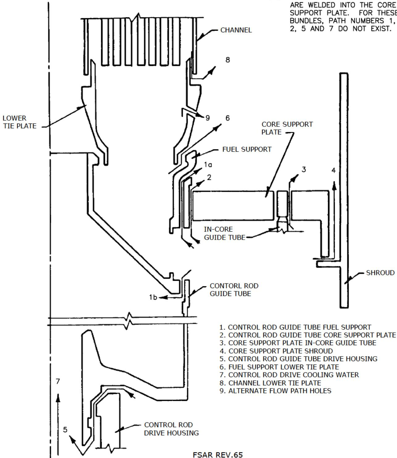
1. CONTROL ROD GUIDE TUBE FUEL SUPPORT
