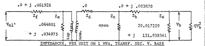
Za - LOCKED ROTOR OF MOTOR BEING STARTED
