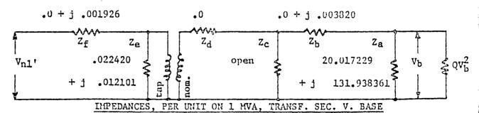
Za - LOCKED ROTOR OF MOTOR BEING STARTED
