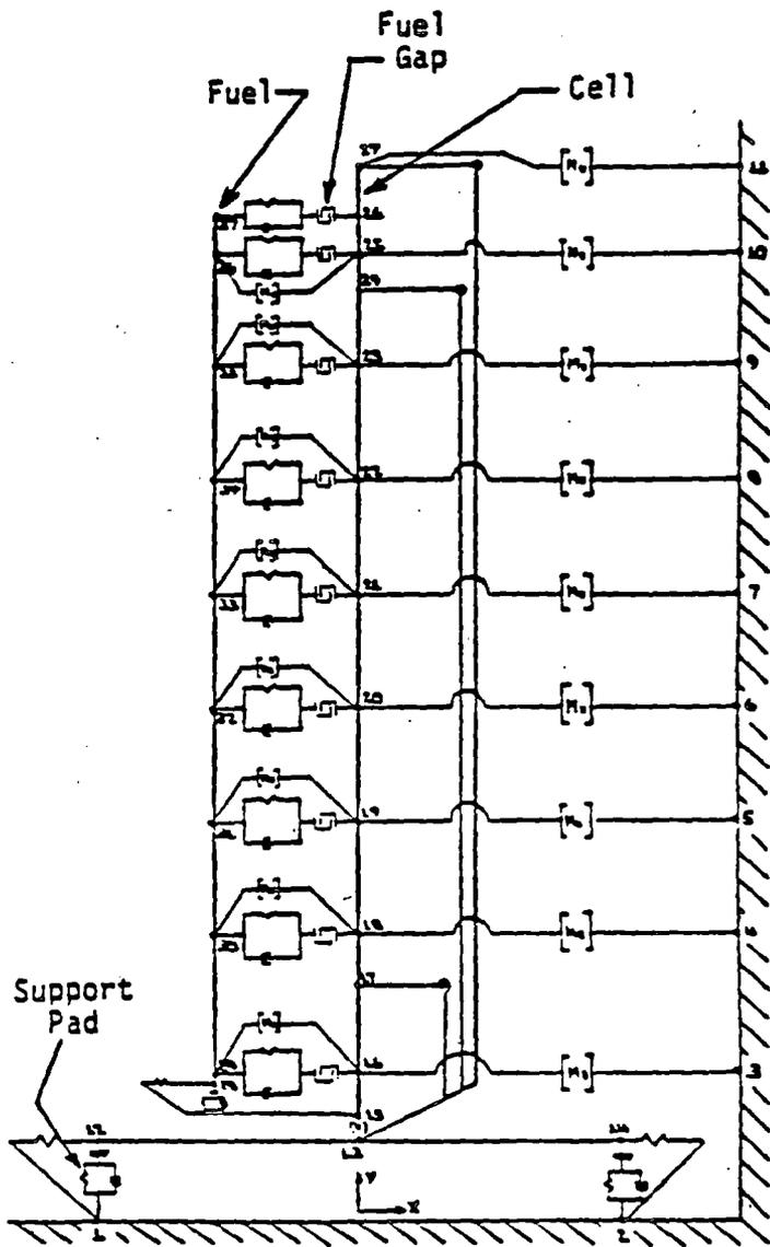
NONLINEAR SEISMIC MODEL
