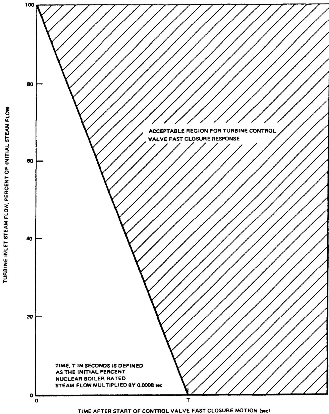
FIGURE 10.2-2. TYPICAL TURBINE CONTROL VALVE FAST CLOSURE CHARACTERISTIC
