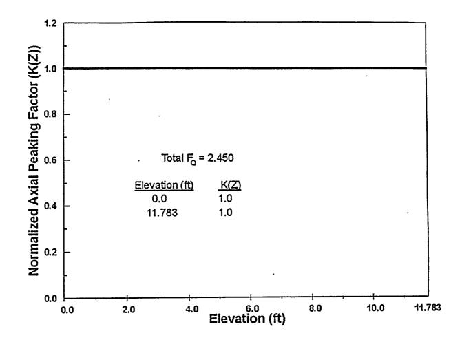
FIGURE 3  $K(Z) - NORMALIZED F_{Q}(Z)$  AS A FUNCTION OF CORE HEIGHT
