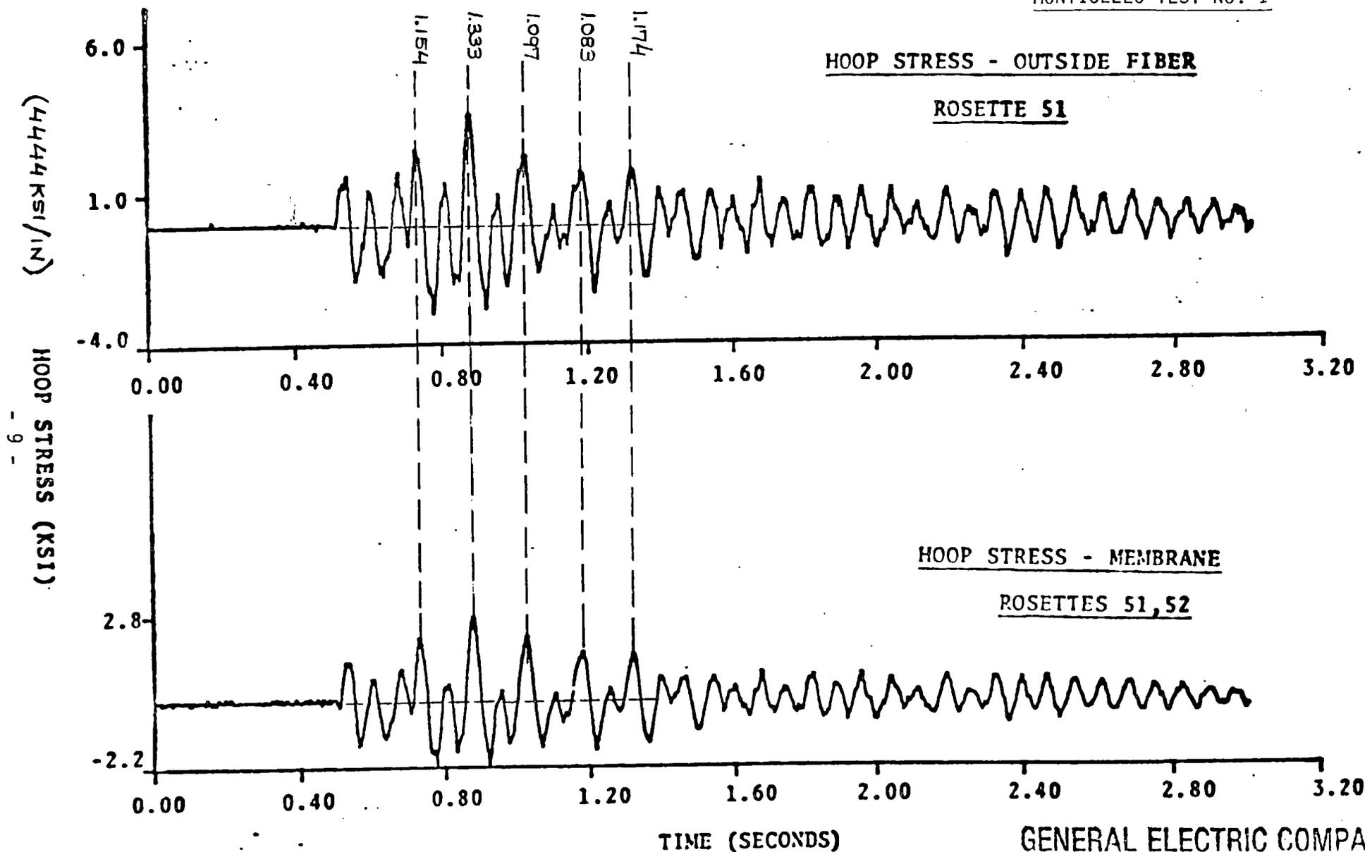
FIGURE 4) OUTSIDE FIBER/MEMBRANE HOOP STRESS TEST 1
